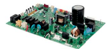
DC invertor pro plynulou regulaci výkonu
